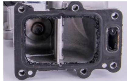
Bruchstücke des Dichtungsmittels können das Thermostat und die Wasserpumpe beschädigen. Verstopfungen können die Kühlleistung mindern.
