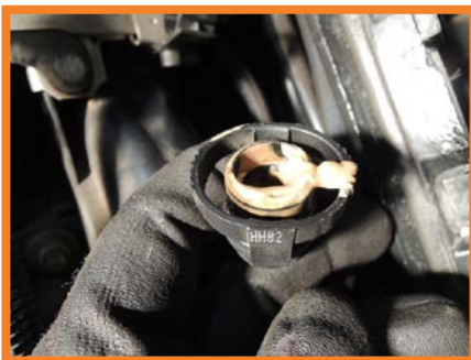
Ölschlamm im Entlüftungsschlauch
