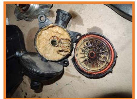
Rückstände im Ölabscheider, BMW 3 (E90), X3
